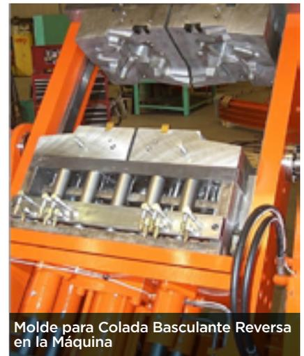
Molde para Colada Basculante Reversa en la Máquina
